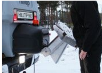
Plus-modell mit klappbaren Edelstahl-Spinner
